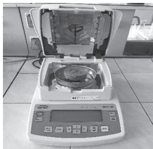
Rys. 1. Stanowisko do oznaczania przepuszczalności pary wodnej wg metody UTH Radom
